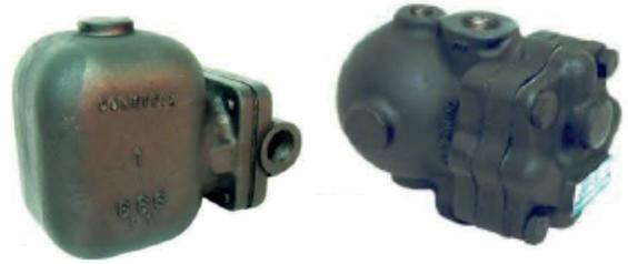
La trampa de flotador Klinger F+T Klinger es una excelente opción para el drenaje de condensado en equipos de calefacción de vapor como intercambiador de calor, serpentines, etc. Permite un mantenimiento fácil y económico. Por otra parte tiene como estándar el eliminador de aire termostático bimetálico, asegurando una gran eficiencia y servicio sin inconvenientes.
